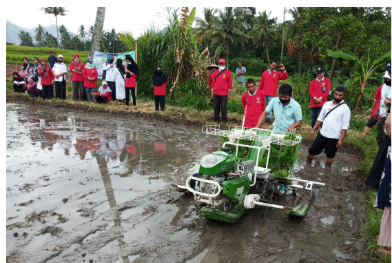
Demonstrasi Pemanfaatan Alsintan Transplanter di Kecamatan Akabiluru
